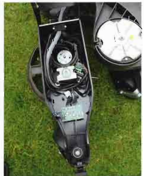
Klappe auf: Steuerplatinen und Verbindungskabel des Roboterjäher sind gut erreichbar.
