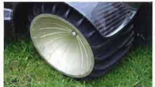
Patenterte Räder: Die konische Form bewirkt, dass die Haftfläche bei trockenem Boden minimiert, bei feuchtem Gelände verstärkt wird. | Fotos: E. Bauer
