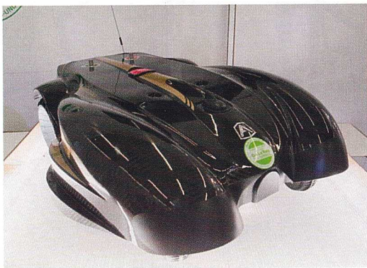
Der Robotmäher Ambrogio Line 400 Elite des italienischen Unternehmens Zucchetti Centro Sistemi Spa verfügt über ein GPS-System, das zu jeder Zeit seine Position erkennt und den Schnitvorgang mit hoher Präzision steuert.
